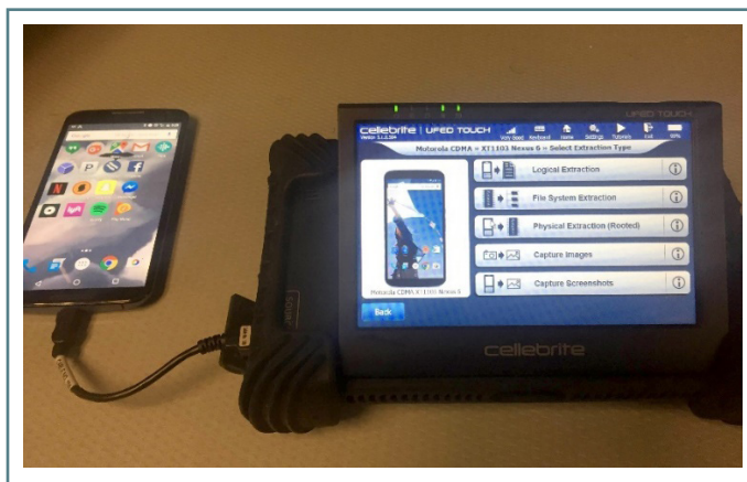
תמונה 1: מערכת UEFD מתוצרת חברת סלברייט המשמשת לפריצה והעתקה של נתונים מטלפונים חכמים שנתפסו על ידי גורמי אכיפה 24
